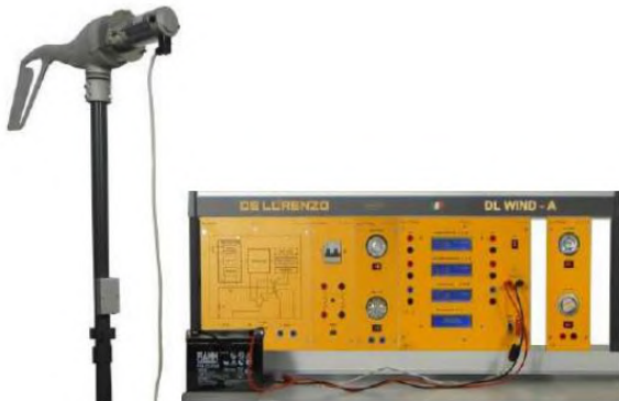
Fig. 3. Modular trainer DL WIND-A1S (De Lorenzo S.p.A.)
