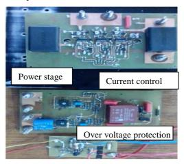
Fig. 9. Buck-Boost Converter Step Up
