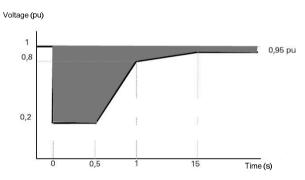
Figure 2. Ride-through capabilities at 3-phase short-circuit. Source: P.O. 12.3. Requisitos de respuesta frente a huecos de tensión de las instalaciones eólicas. Spanish grid code.
